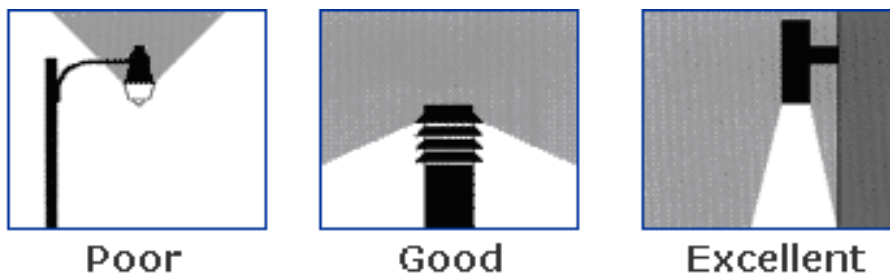
Figura 3. Fuentes de iluminación indicando su eficiencia para evitar la desorientación de las tortugas marinas en las playas de anidaje.
